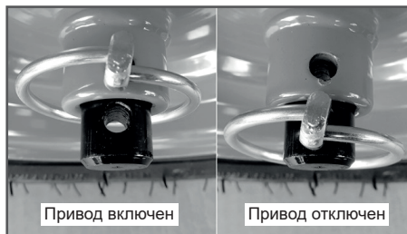
Рис.26 Перестановка шплинта на левом колесе
