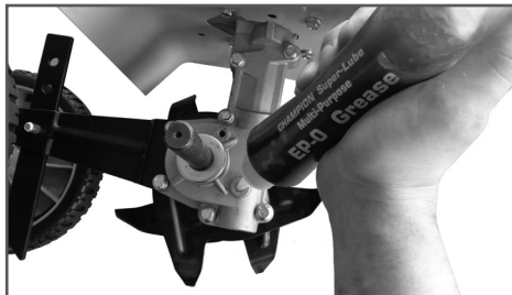
Рис. 24 Добавление смазки в корпус редуктора
