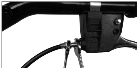
Рис. 12 Фиксация троса газа
