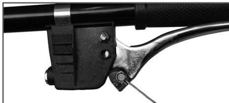
Рис. 9 Установка наконечника троса газа
