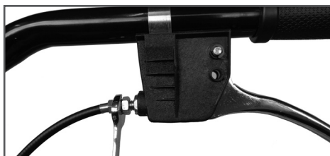
Рис. 10 Установка регулировочной муфты троса газа
