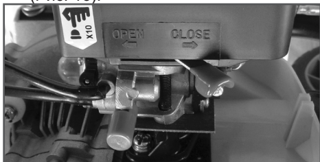
Рис. 16 Воздушная заслонка карбюратора закрыта
