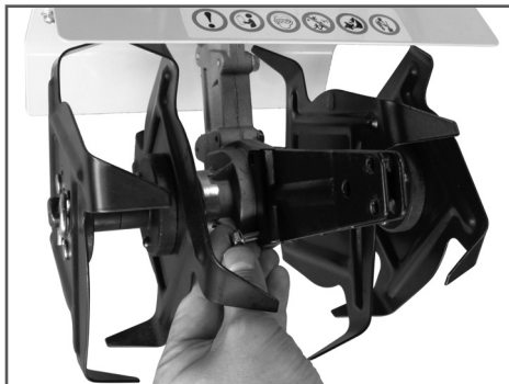
Рис. 5 Установка кронштейна сошника
