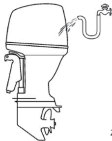
2. Полностью слейте из мотора охлаждающую воду. Тщательно вымойте корпус.
