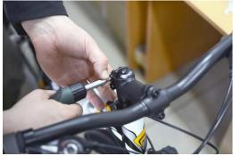
Проверьте тормоза, если тормозные колодки цепляют диск (обод), произведите настройку, как показано на фтотографии, при помощи регулировочных болтов, позволяющих менять зазор между колодками.
