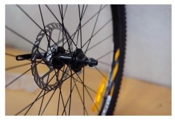
Аккуратно установите колесо в проушины вилки. Затем плотно прижав вилку к колесу сверху, заверните гайку до упора и выжмите лапку эксцентирка, чтобы надежно закрепить колесо.
