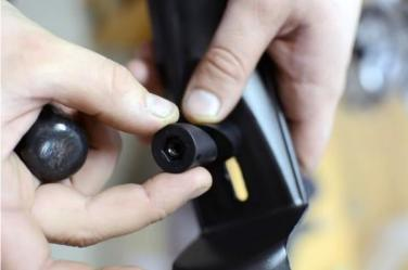
Соберите крепеж, но не затягивайте его. Втулки должны иметь свободный ход. Наденьте на втулку проставочное кольцо и установите конструкцию в отверстие штока вилки. Выдерживая положение крыла вдоль хода движения, затяните болт.
