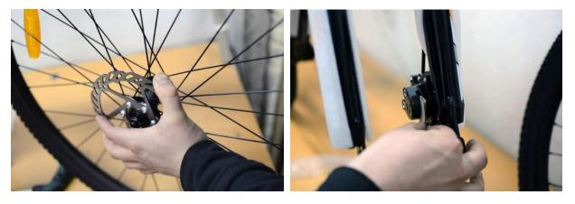
Для установки переднего колеса потребуется эксцентрик из коробки с комплектующими. Снимите гайку и одну конусную пружину эксцентрика и установите его в ось втулки и, установив пружину, наживите гайку на 2-3 оборота как показано на фотографии. Имейте ввиду, что конусная пружина должна быть обращена широким концом к гайке.
