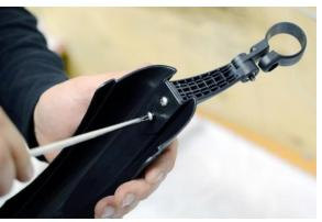
Соберите гайку-барашек из гайки и пластмассовой формы. При помощи болта и гайки-барашка закрепите заднее крыло под нужным углом.
