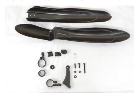
На фотографии ниже показаны детали, предназначенные только для крепления переднего крыла: болт 50 мм, шайба, две распорные втулки, нанизываемые на болт, гайка, проставочное кольцо.
