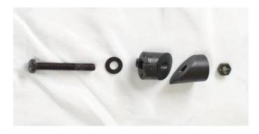
Обратите внимание, что втулка со шлицом устанавливается со стороны головки болта. Вторая втулка имеет углубление для гайки. Крепеж собирается так, чтобы переднее крыло находилось между шайбой и шлицевой втулкой. Шлицы втулки при этом погружаются в вырез крыла и предохраняют втулку от вращения.
