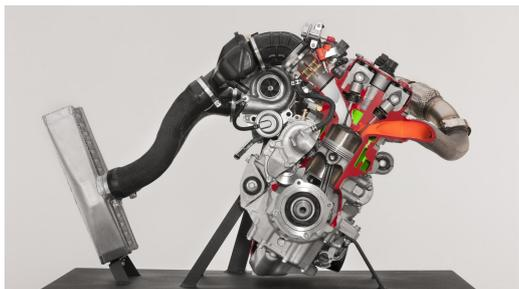
**Genesis Turbo 998cc 4-тактный двигатель**
