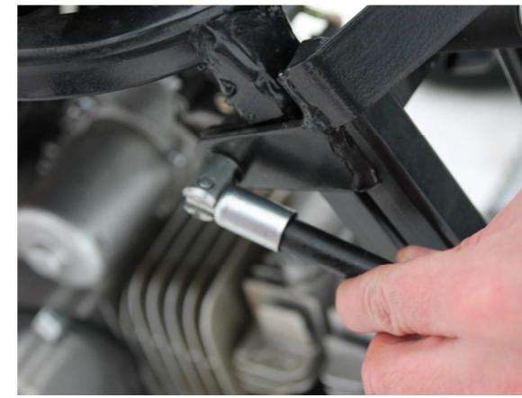
15. Тянем на себя рулевой вал и снимаем переднюю подвеску.
