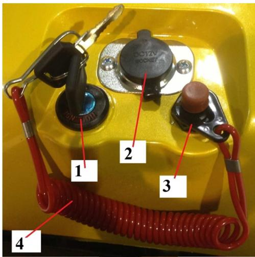
1. **Замок зажигания:** Замок зажигания расположен на панели за бензобаком. Положение «OFF» - вся цепь разорвана; ключ может быть вынут из замка зажигания. Положение «ON» - вся цепь замкнута; двигатель можно запустить; ключ вынуть нельзя.
