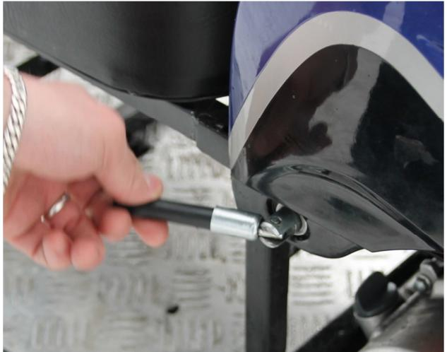
2. Открутив барашек крепления пластика, расположенного над фарой, отгибаем и снимаем пластик блока двигателя.
