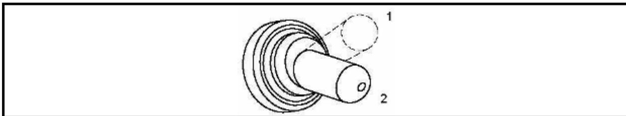
Рисунок 13 – Выключатель нагревателей рукояток руля и рычага газа
