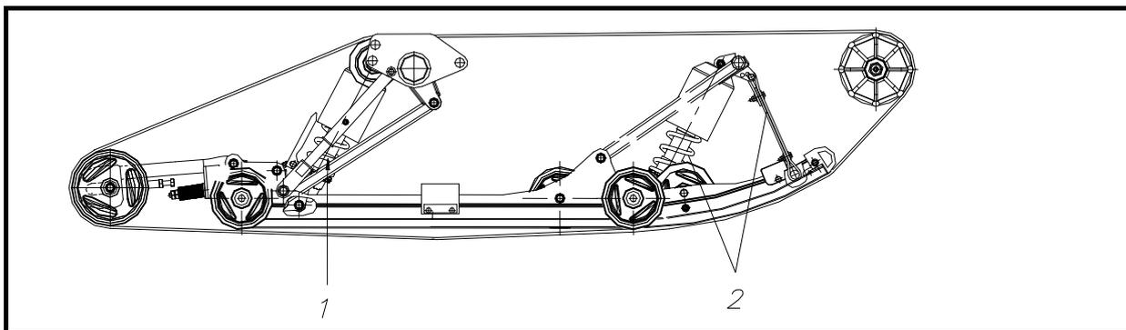
Рисунок 25 – Регулировка задней подвески (снегоходы ТАЙГА Атака 551 II)
