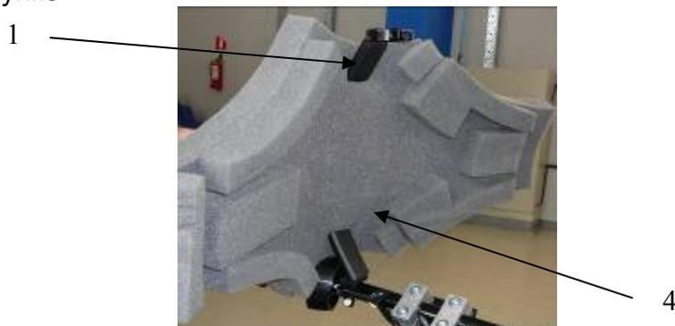
в) закрепите второй конец держателя поз. 1 на руле при помощи болта поз. 2 и гайки поз. 3
