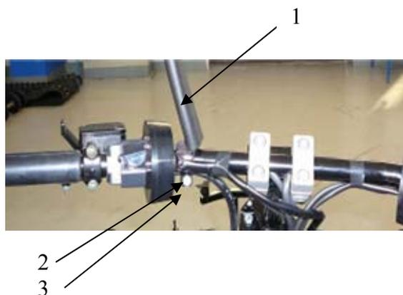
б) проденьте держатель поз. 1 через отверстия в наполнителе поз. 4, как показано на рисунке
