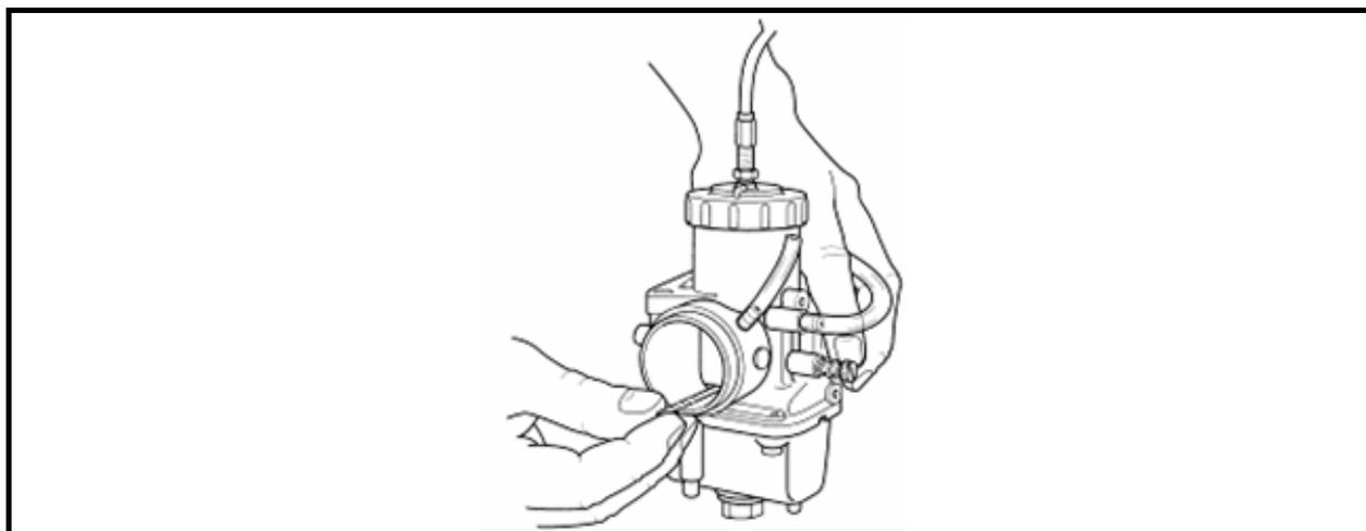
Рисунок 19 – Проверка зазора
