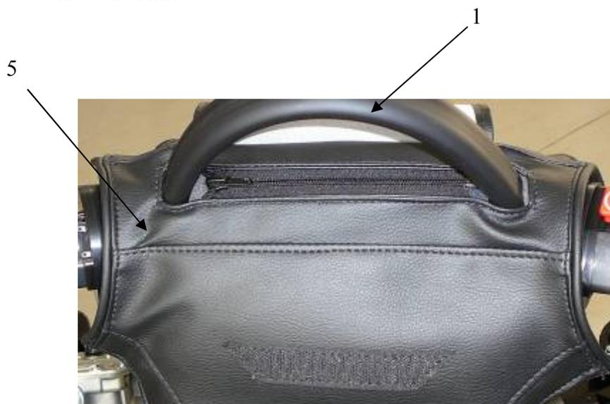
е) застегните боковые молнии. При выступании наполнителя из-под чехла руля снизу допускается подрезка наполнителя
