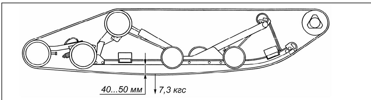
Рисунок 27 – Регулировка задней подвески снегохода ТАЙГА Варяг 550 (С40005000-01)
