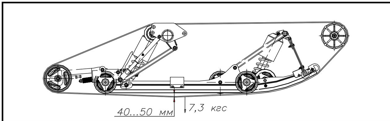
Рисунок 21 – Проверка натяжения гусеницы снегохода ТАЙГА Атака 551 II
