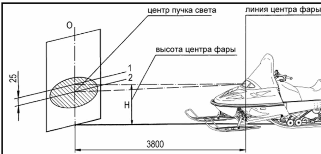
Рисунок 33 – Регулировка фары
