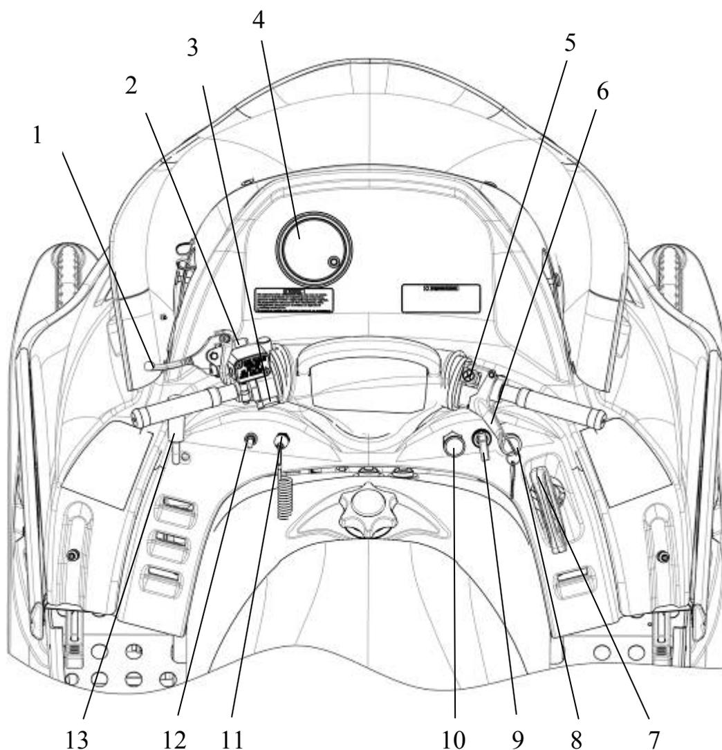
1 – рычаг тормоза; 2 – рычаг стояночного тормоза; 3 – переключатель света фары; 4 – спидометр; 5 – выключатель экстренного останова двигателя; 6 – рычаг газа; 7 – рукоятка ручного пуска двигателя; 8 – замок зажигания; 9 – рычаг топливного корректора карбюратора; 10 – ручка подкачивающего насоса; 11 – выключатель аварийного останова двигателя со шнуром; 12 – выключатель нагревателей рукояток руля и рычага газа; 13 – рычаг переключения передач.
