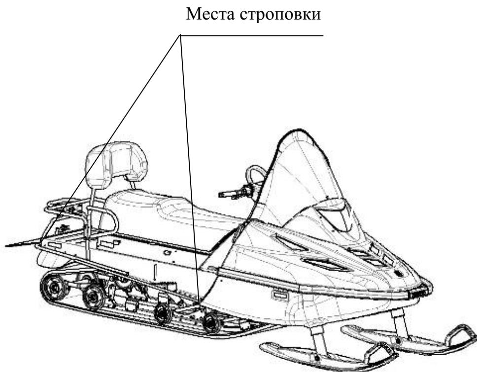
Рисунок 14 – Строповка снегохода
