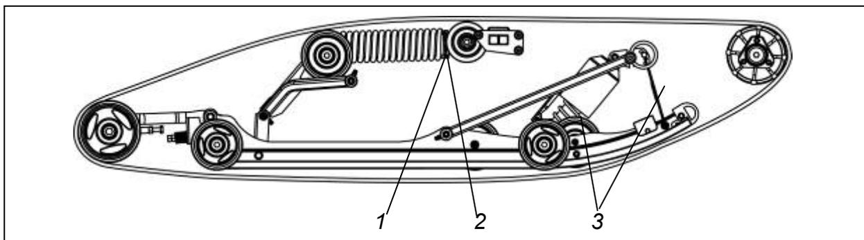
Рисунок 25а – Регулировка задней подвески снегохода ТАЙГА Варяг 550 (С40005000-05)
