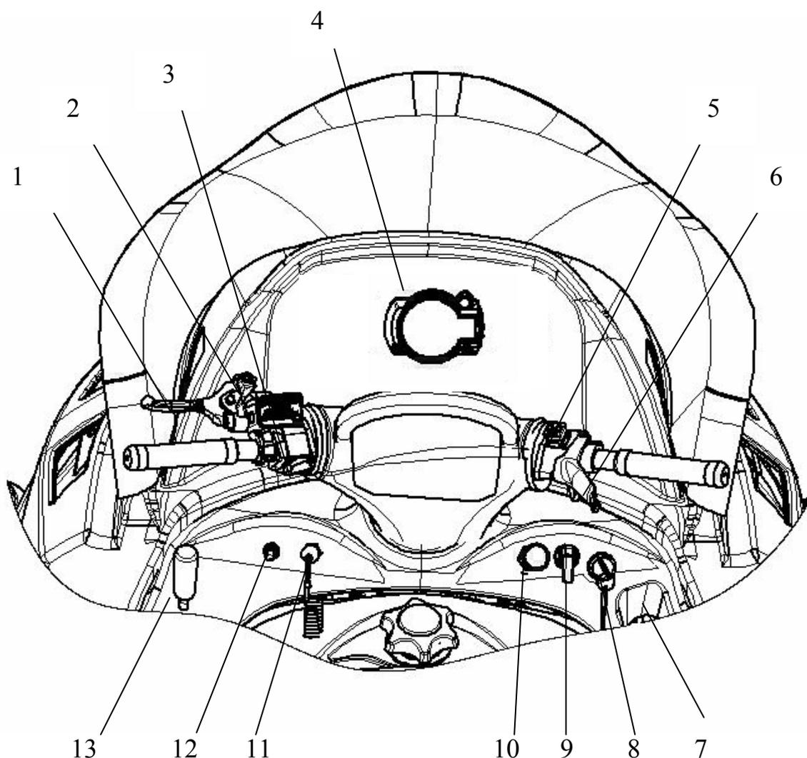
1 – рычаг тормоза; 2 – рычаг стояночного тормоза; 3 – переключатель света фары; 4 - комбинация приборов; 5– выключатель экстренного останова двигателя; 6 – рычаг газа; 7 – рукоятка ручного пуска двигателя; 8 – замок зажигания; 9 – рычаг топливных корректоров карбюраторов; 10 – ручка подкачивающего насоса; 11 – выключатель аварийного останова двигателя со шнуром; 12 – выключатель нагревателей рукояток руля и рычага газа; 13 – рычаг переключения передач
