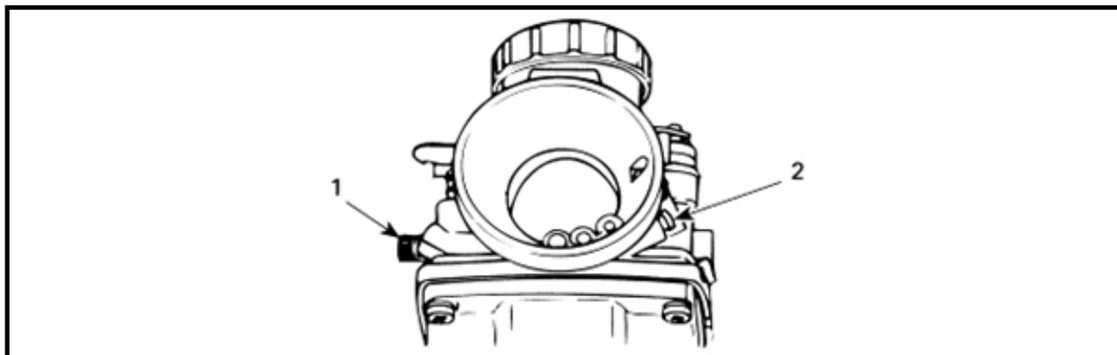
Рисунок 18 – Регулировка карбюратора
