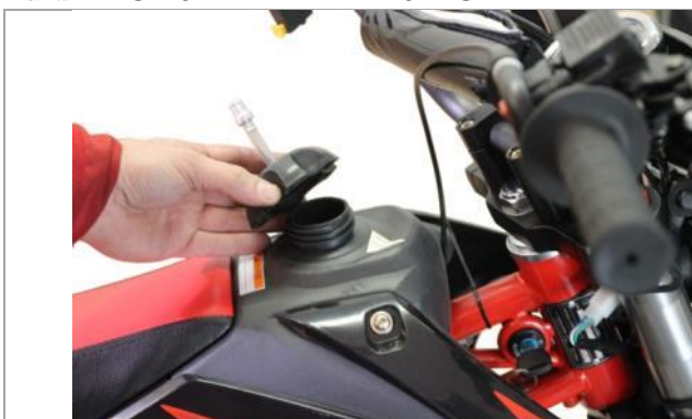
3.11.1. Установите крышку бензобака, как показано на фотографии.
