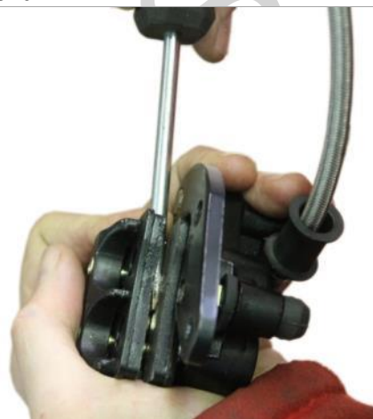
3.6.3. Разожмите колодки при помощи плоской отвёртки, чтобы облегчить процесс установки на тормозной диск.
