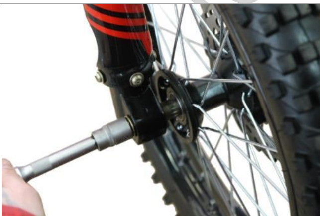
3.5.9. Затяните осевой болт.
