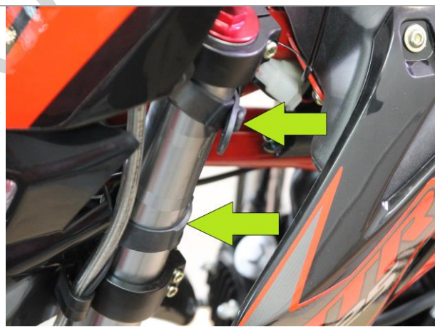
3.7.3. Зафиксируйте хомуты, которые находятся на фаре, к левой стойке амортизаторов и выровняйте фару.
