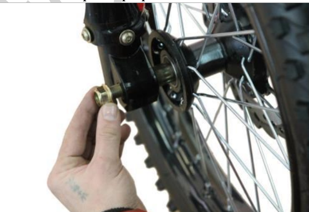
3.5.8. Вставьте осевой болт через втулку в правую вилку амортизатора и накрутите гайку.
