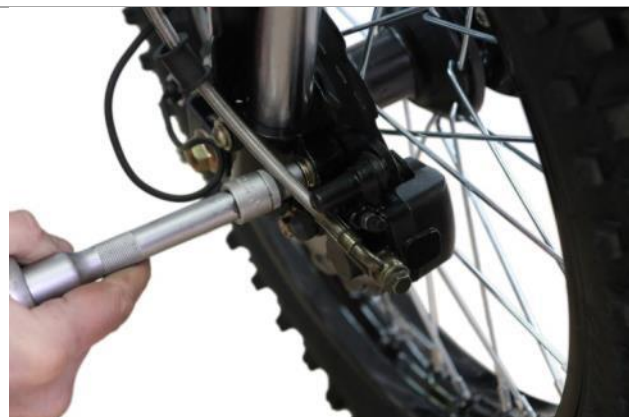
3.6.5. Затяните болты, которые были выкручены ранее.
