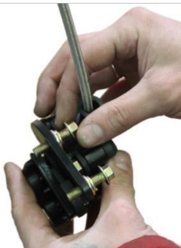
3.6.1. Выкрутите крепёжные болты из тормозного суппорта.
