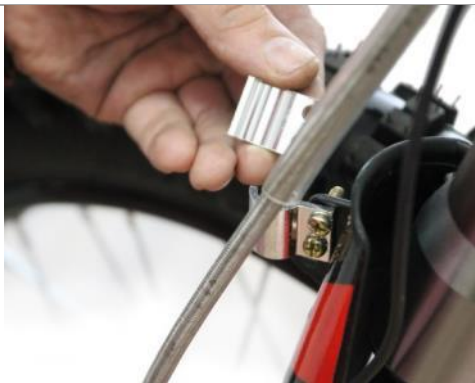
3.6.6 Зафиксируйте тормозной шланг хомутом, который находится на левом амортизаторе.
