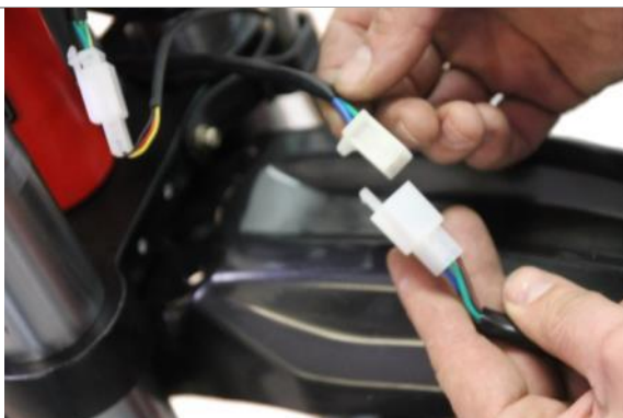
3.7.1. Соедините клемму на фаре головного света и клемму на мотоцикле, как показано на фотографии.
