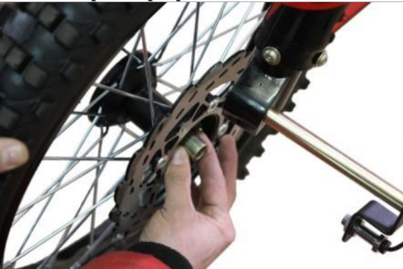
3.5.5. В диск переднего колеса с левой стороны мотоцикла установите втулку.
