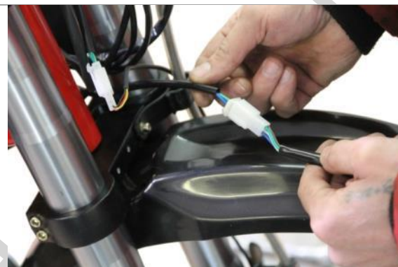
3.7.1. Соедините клемму на фаре головного света и клемму на мотоцикле, как показано на фотографии.
