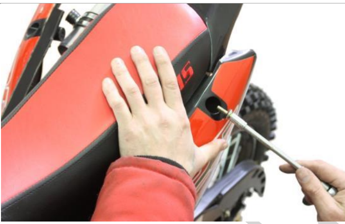
3.10.4. Закручиваем ранее выкрученные болты крепления сиденья через боковой пластик, как показано на фотографии.
