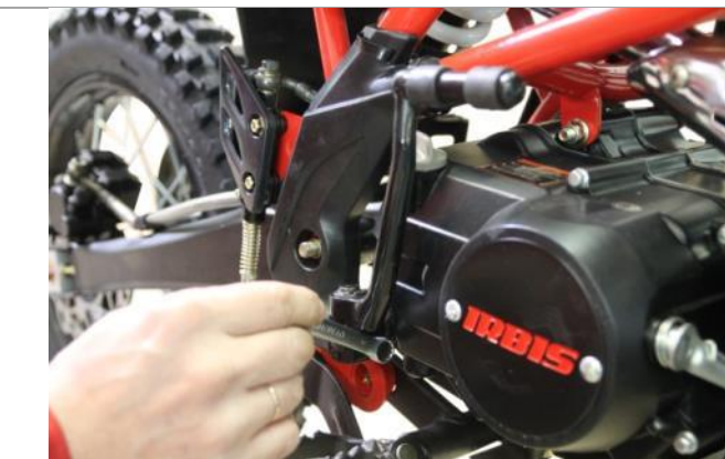
3.12.2 Затяните болт накидным ключом.
