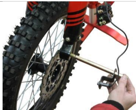
3.5.4. Далее проденьте ось через левую вилку амортизатора.
