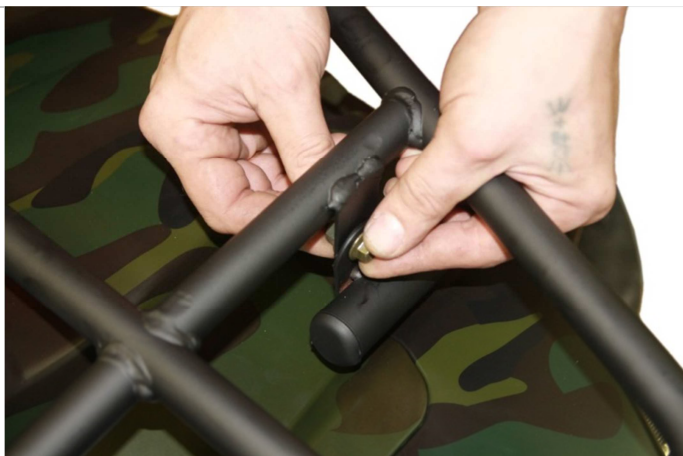
3.5.5. С помощью болта М8 и гайки фиксируем передний отбойник с передним багажником .
