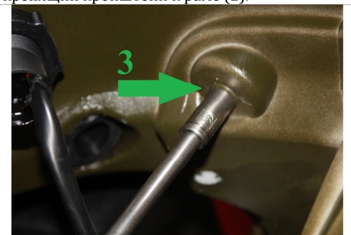
3.5.9. После установки кронштейна (1) в нужное положение, с помощью болта М6 снизу скручиваем кронштейн с багажником. После этого окончательно закручиваем весь крепеж.
