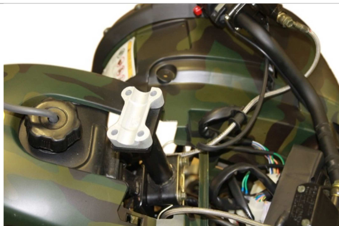
3.1.1. Установите нижнюю часть хомута крепления руля на рулевую рейку
