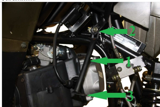
3.5.8. Переводим силовой кронштейн крепления багажника (1) в положение, как указано на рисунке 3.5.9, так, чтобы часть кронштейна (3) уперлась в пластик переднего крыла (данный кронштейн находится рядом с передним колесом). Для этого предварительно необходимо ослабить бол, крепящий кронштейн к раме (2).
