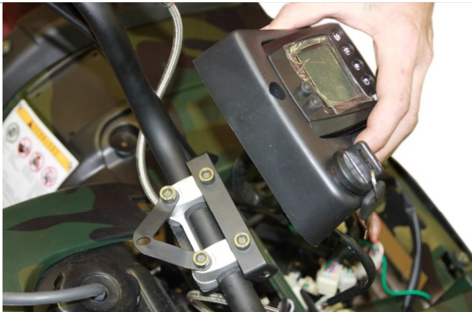
3.2.2. Устанавливаем приборную панель на планки крепления.
