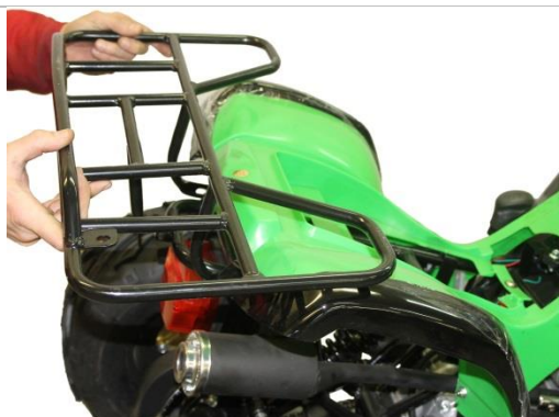
3.3.4. Установите задний багажник таким образом, чтобы совпали отверстия под крепёжные болты.
