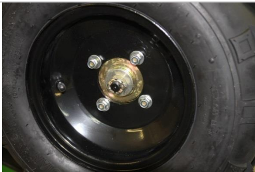
3.4.10. Наденьте шайбы и закрутите гайки.
