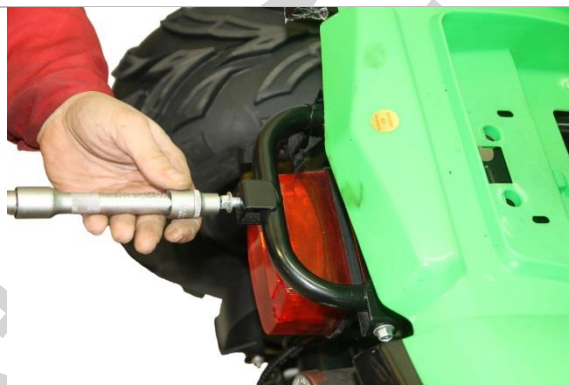
3.3.2. Выкрутите из задней части рамы болт крепления заднего багажника головкой на 10мм., как показано на фотографии.
