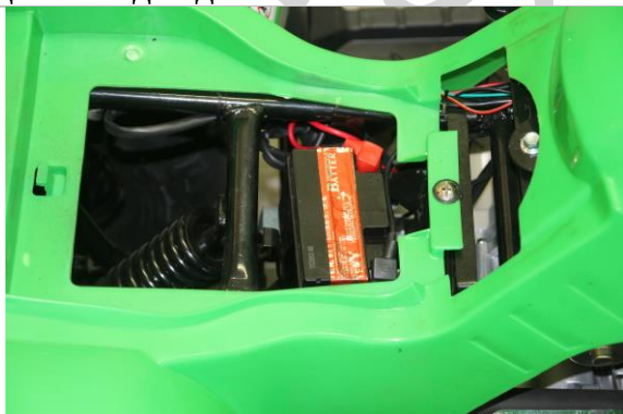
3.5.3. Установите клеммы согласно полярности, где красный это «+», черный соответственно «-».
