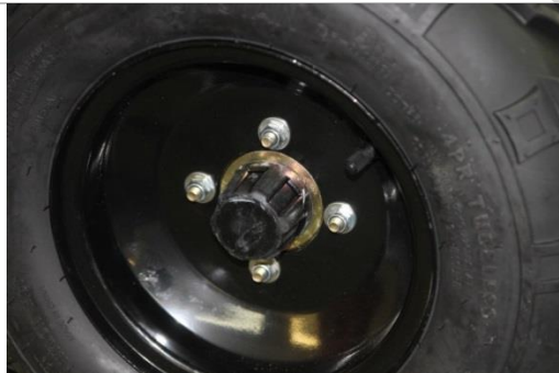
3.4.11. Затяните гайки головкой на 10мм.
