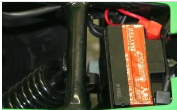
3.5.3. Установите клеммы согласно полярности, где красный это «+», черный соответственно «-».
