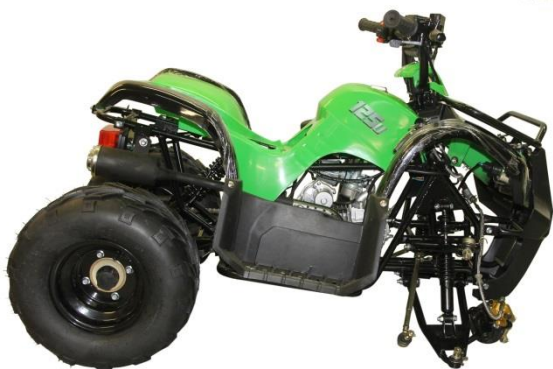
3.3.1. Установите квадроцикл в горизонтальное положение, вытащив подставку и металлическое основание каркаса.
