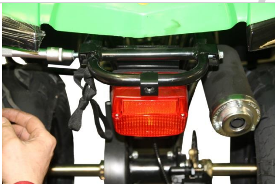
3.3.3. Выкрутите два болта с двух сторон рамы головкой на 10мм., как показано на фотографии.
