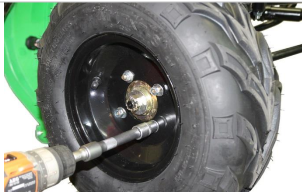
3.4.11. Затяните гайки головкой на 10мм.
