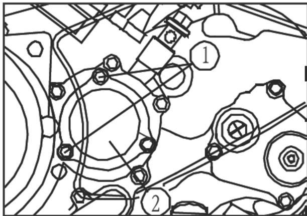
1. Болты крепления крышки масляного фильтра
