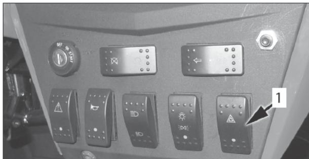
1. Выключатель аварийной сигнализации
